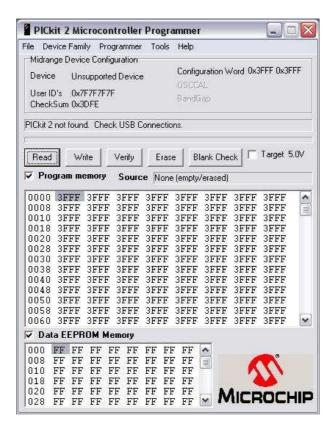
Lors de la connection à un PIC compatible ICSP, le logiciel détecte automatiquement le modèle, et est capable de lire et d'écrire les différentes informations (mémoire, EEPROM, fusibles) sur ce dernier. Vous pouvez voir que le maniement est fort simple: 5 boutons suffisent au fonctionnement, les menus ne servant que rarement, exepté "File", car c'est par ce dernier que l'on importe/exporte le fichier Hex.
